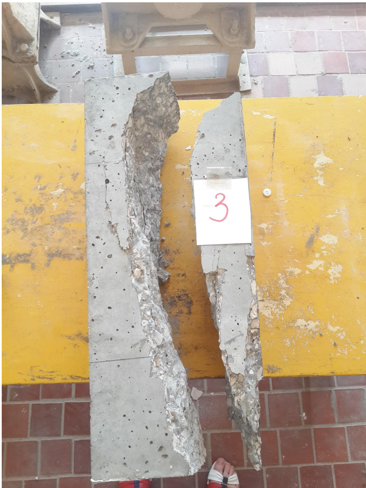
Рисунок А.7 - Наглядный пример линии разрушения Образца №3
