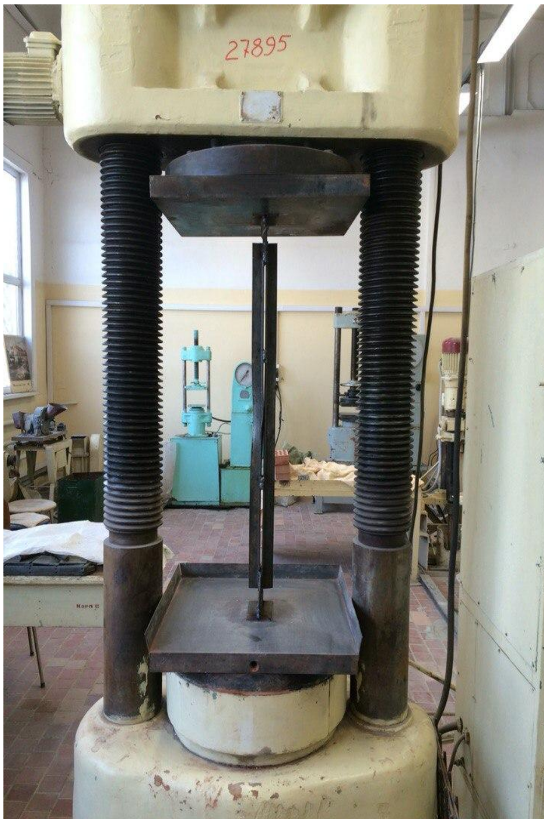
Рисунок 10 - Вид деформированного стержня до испытаний
