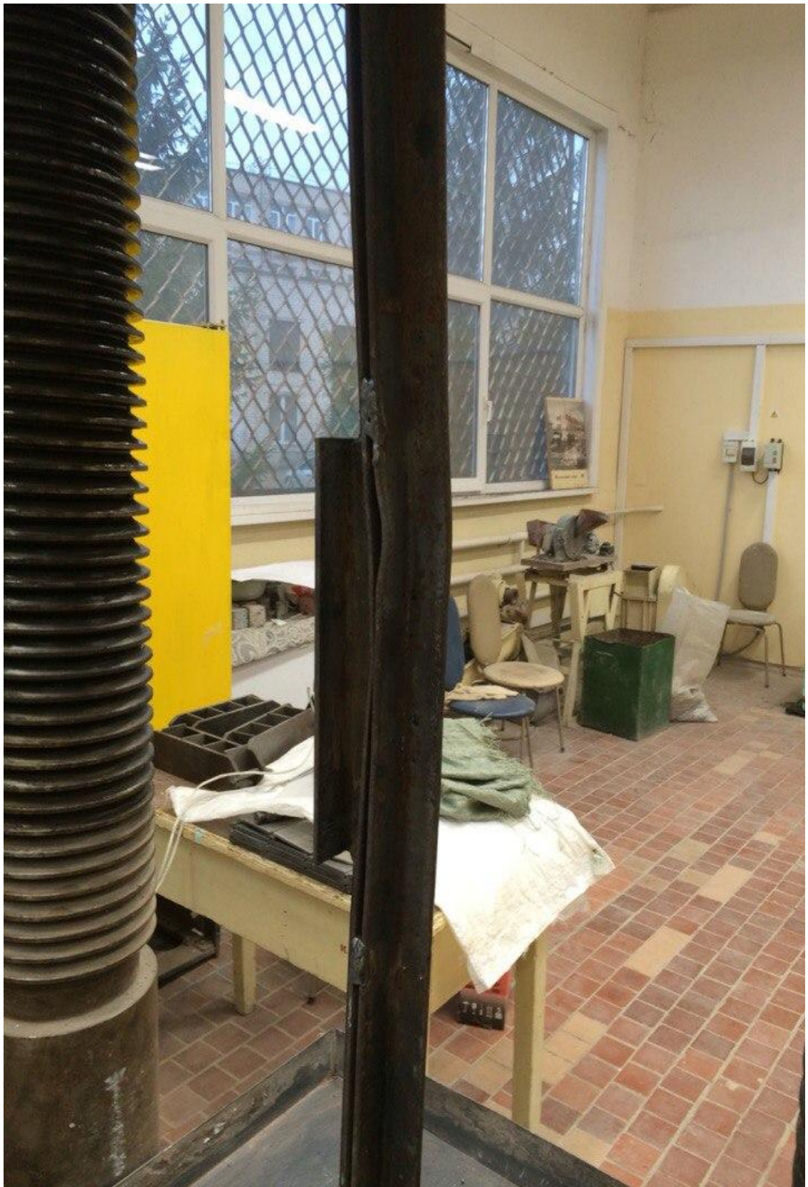
Рисунок Г.2 - Вид стержней усиливаемых уголком после испытаний
