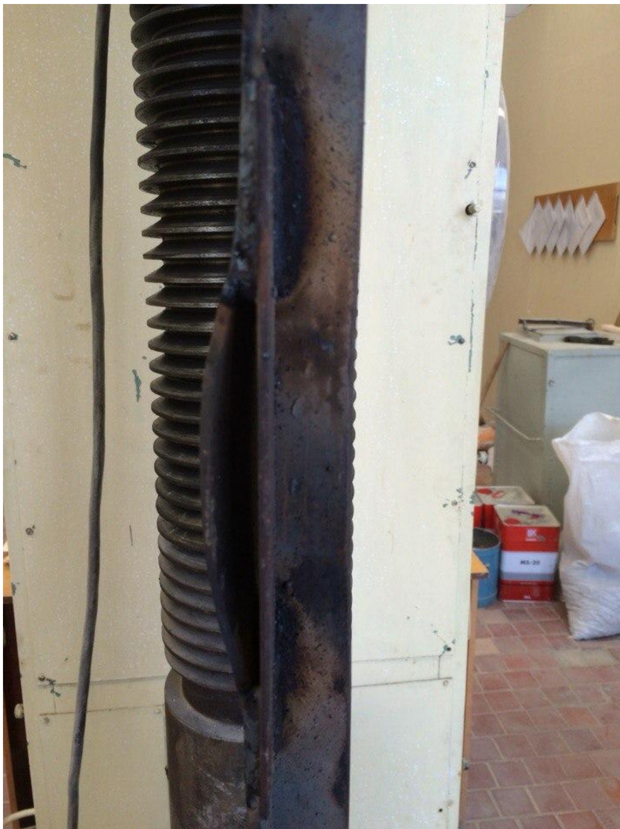
Рисунок В.5 - Вид усиливаемых стержней полосой до испытаний
