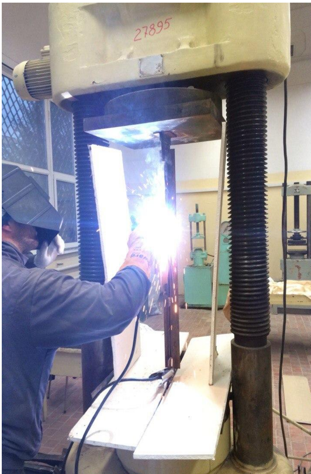
Рисунок Г.1 - Усиление деформированных стержней уголком под нагрузкой
