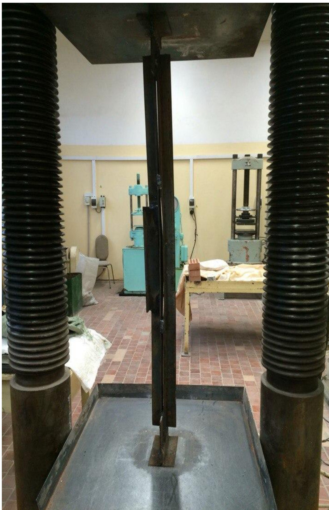
Рисунок В.3 - Вид усиливаемых стержней уголком до испытаний
