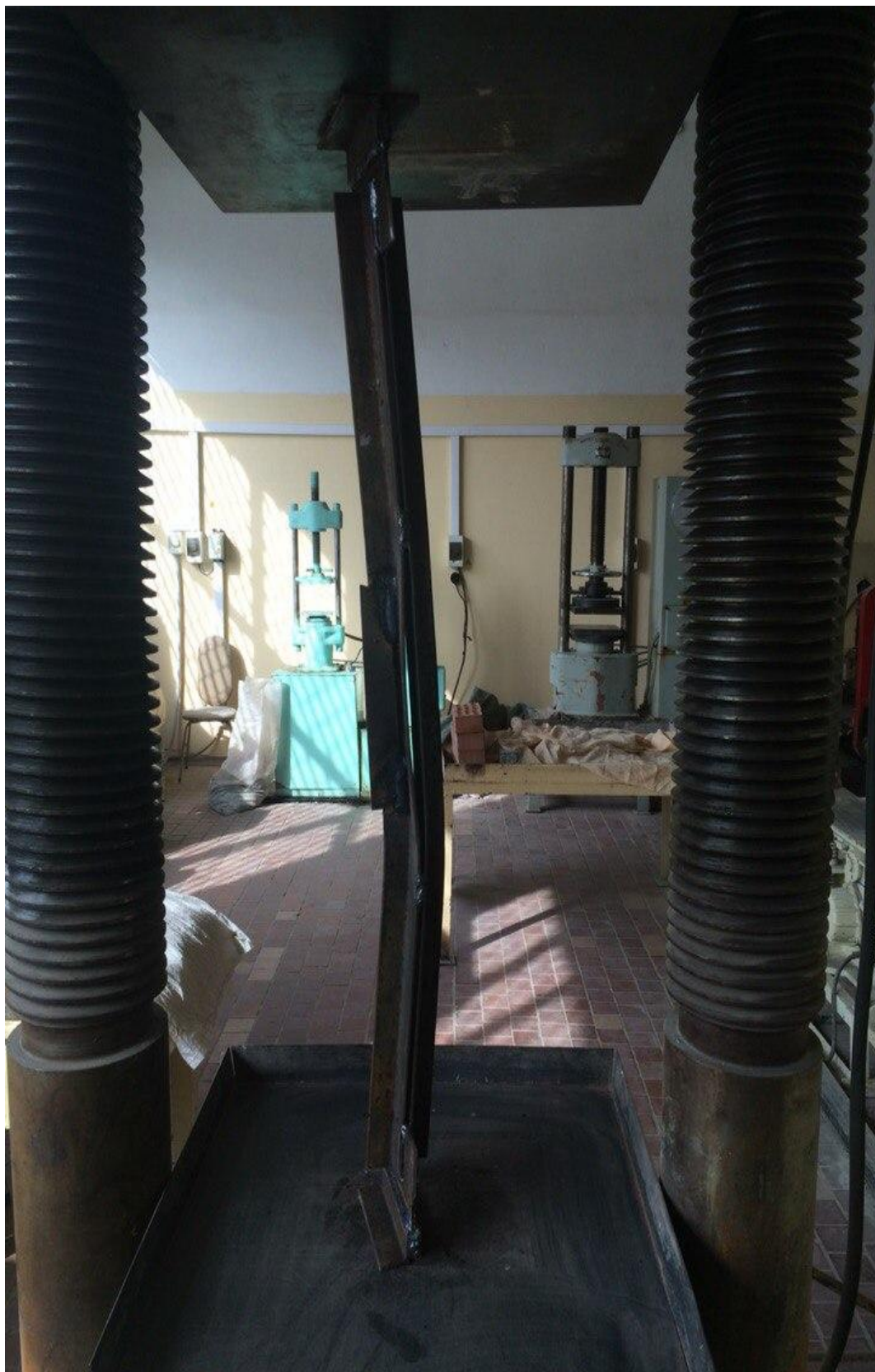
Рисунок В.2 - Вид усиливаемых стержней полосой после испытаний
