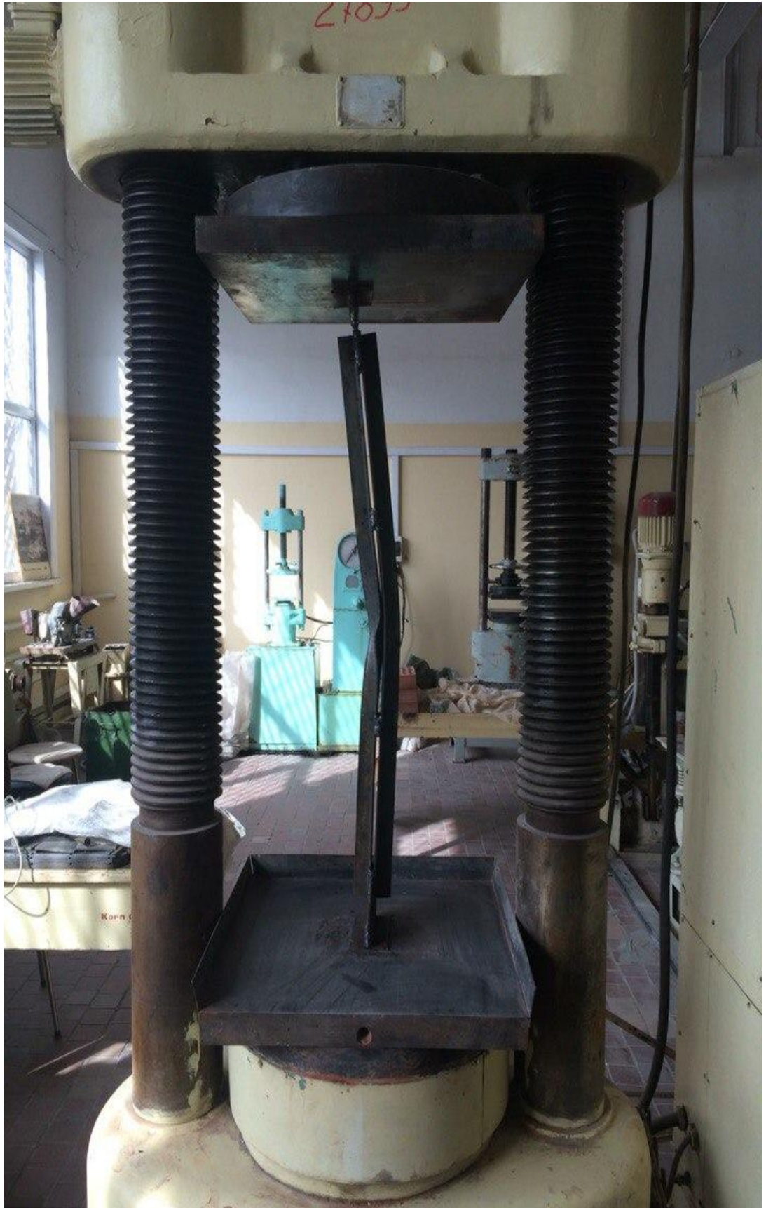
Рисунок Б.2 - Вид деформированного стержня после испытания
