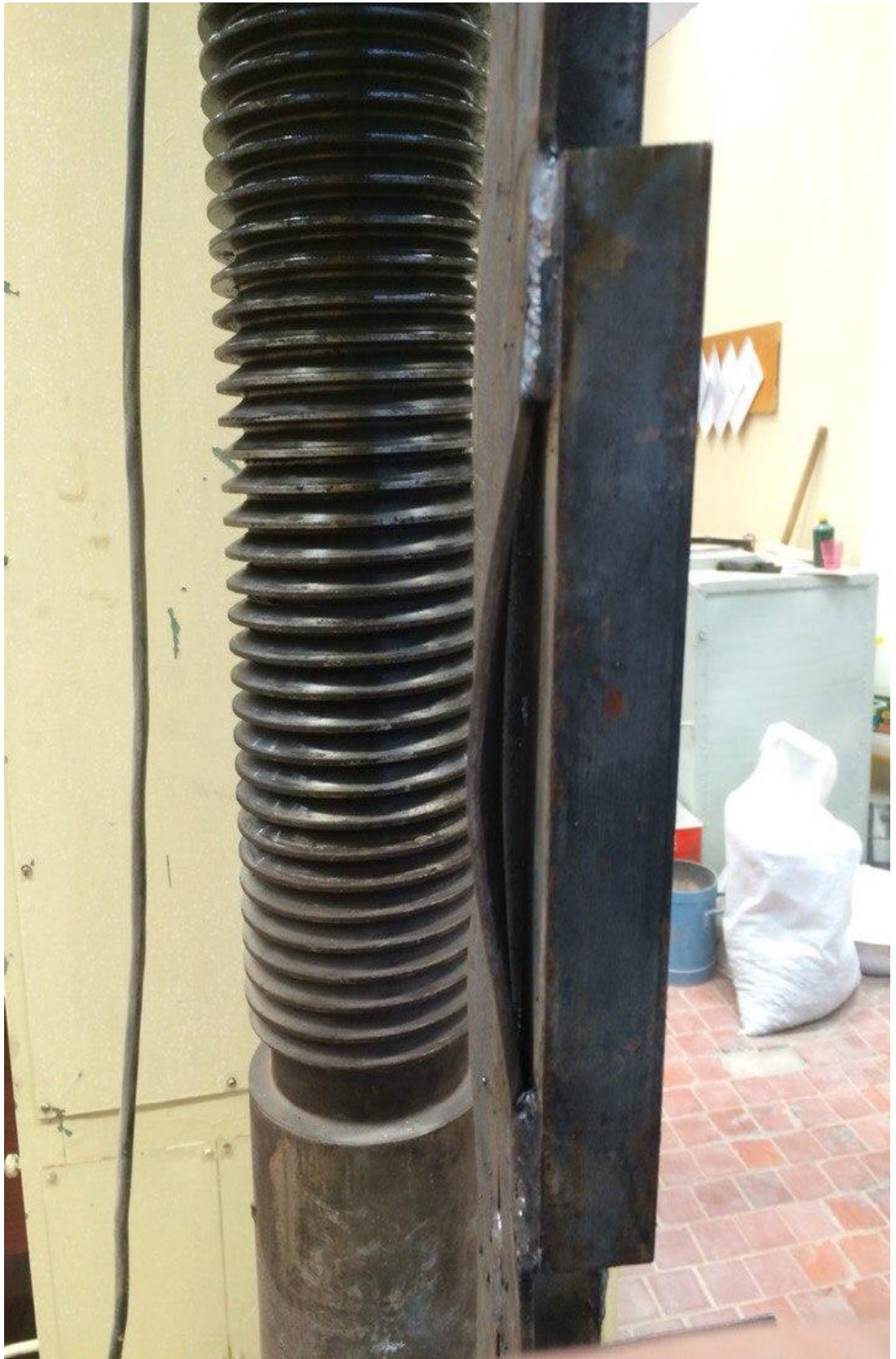
Рисунок В.4 - Вид усиливаемых стержней уголком до испытаний
