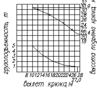
Рисунок 5.1 – Грузовая характеристика крана
