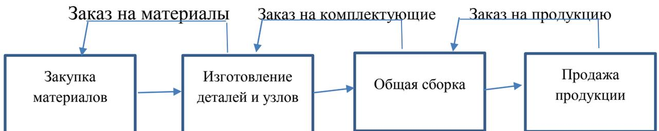
Рисунок 11 – Схема организации производства с применением системы Just-in-Time
