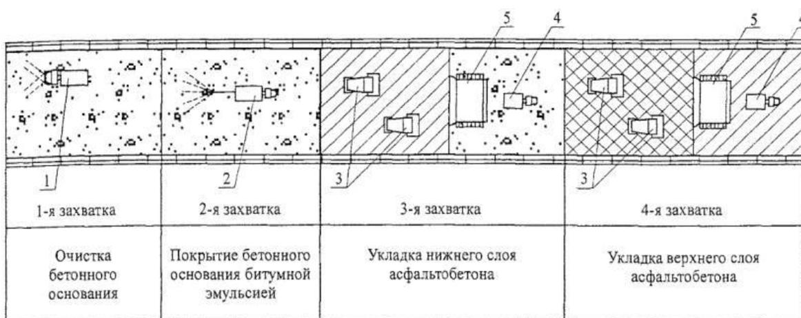
Рисунок 1 - Технологическая схема устройства асфальтобетонного покрытия дороги
