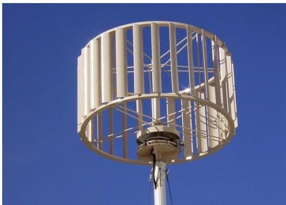
Рисунок 26 - Многолопастный ротор
