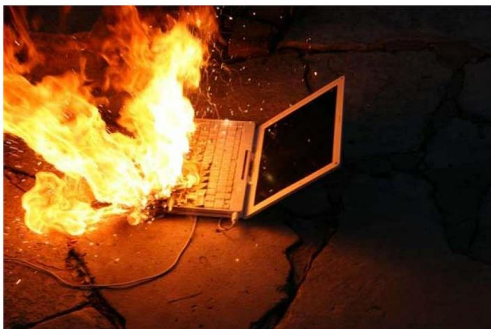
Рисунок 36 - Результат возгорания литиевого аккумулятора
