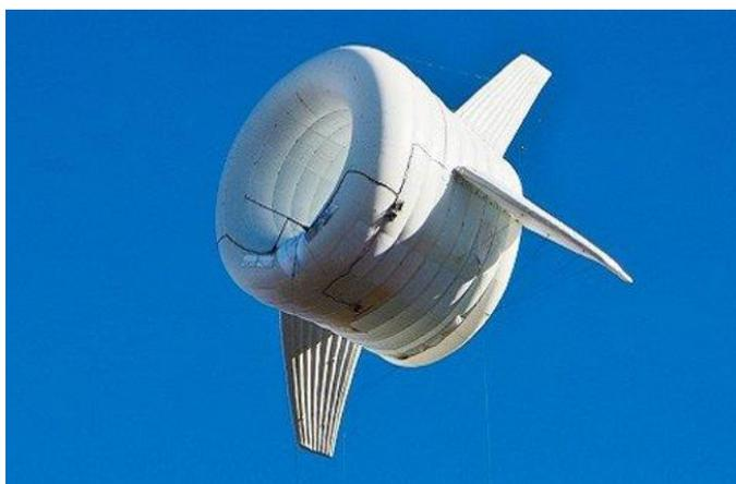
Рисунок 27 – Ветрогенератор на воздушном змее
