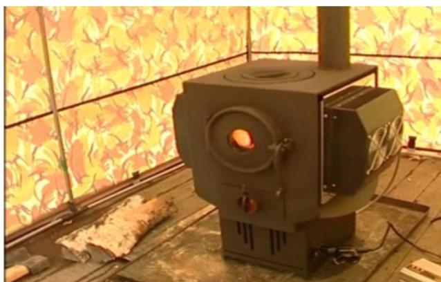
Рисунок 34 - Печь «Индибирка» с термоэлектрогенератором
