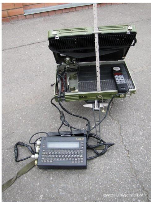
Рисунок 15 - Портативная система спутниковой связи Р-438М
