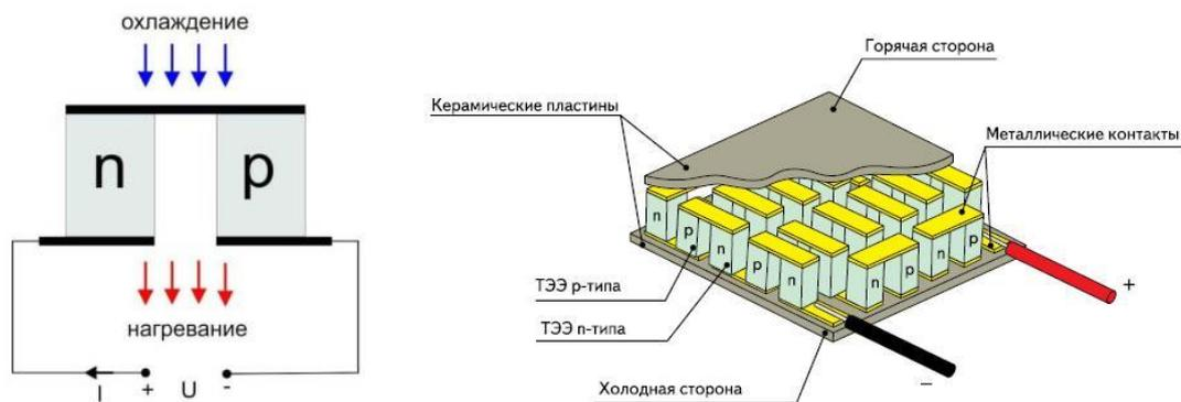
Рисунок 33 - Конструкция модуля Пельтье
