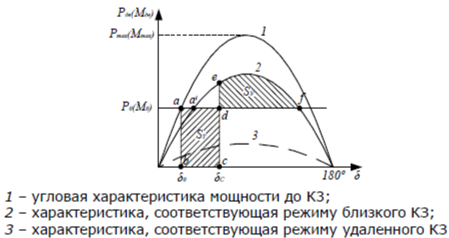
Рисунок 3 – Характеристики мощности синхронного двигателя в различных режимах
