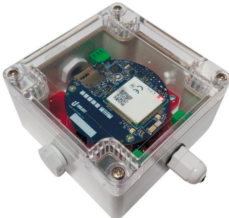
Рисунок 19 – Модуль индивидуального управления светильником Unilight BOX
