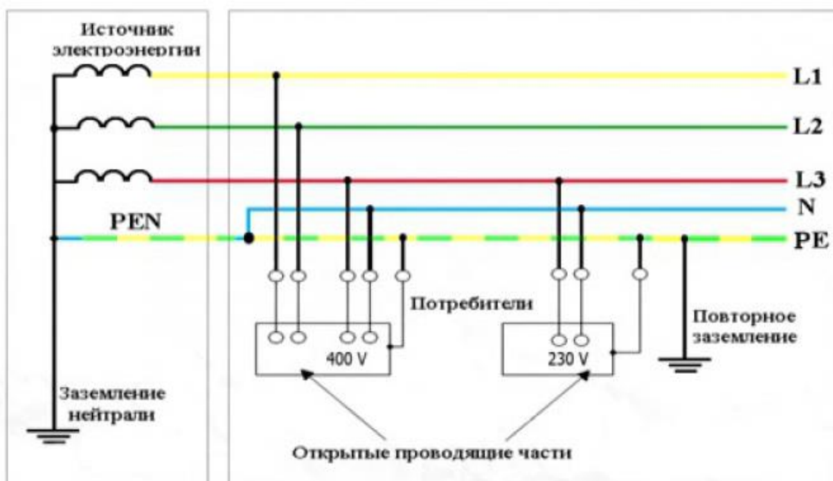
Рисунок 7 – Схема соединения нейтрали TN-C-S
