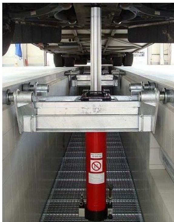
Рисунок 5 – Подвесной подъемник для осмотровой канавы JZ-RH 10/800 E
