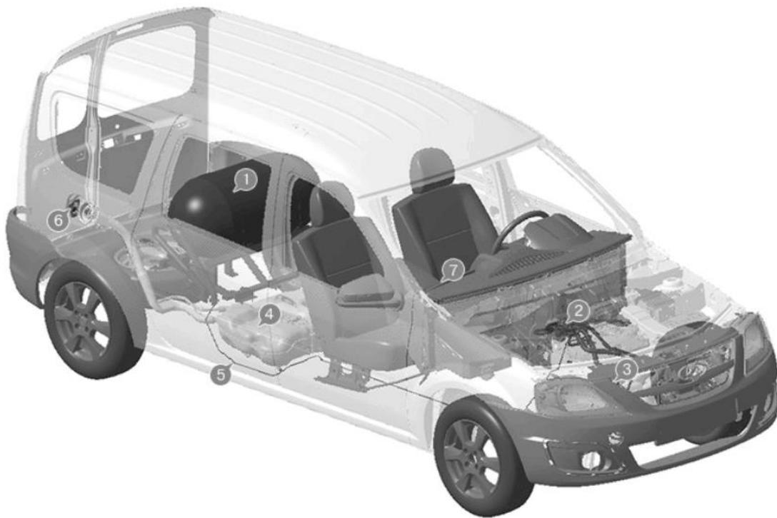
Рисунок 4.4 – Компоненты автомобиля Lada Largus CNG: 1. Газовый баллон; 2. Редуктор газовый; 3. Газовая рампа; 4. Топливный бак (бензин) 5. Газовая магистраль высокого давления; 6. Заправочное устройство; 7. Кнопка переключения типа топлива: газ/бензин [18]
