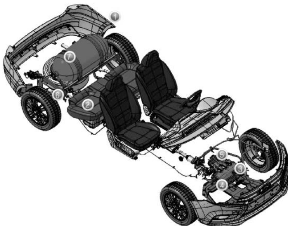
Рисунок 4.3 – Компоненты автомобиля Lada Vesta CNG: 1. Заправочный штуцер; 2. Топливный бак (бензин); 3. Модуль впуска; 4. Газовая рампа; 5. Редуктор газовый; 6. Выпускная система; 7. Газовый баллон
