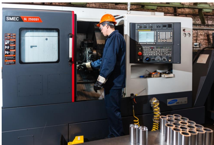
Рисунок 2.4 - Токарный центр SMEC SL 1500 с ЧПУ CT16A25
