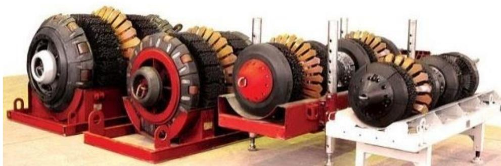
Рисунок 2.4 – Внутритрубный магнитный дефектоскоп ДМТ
