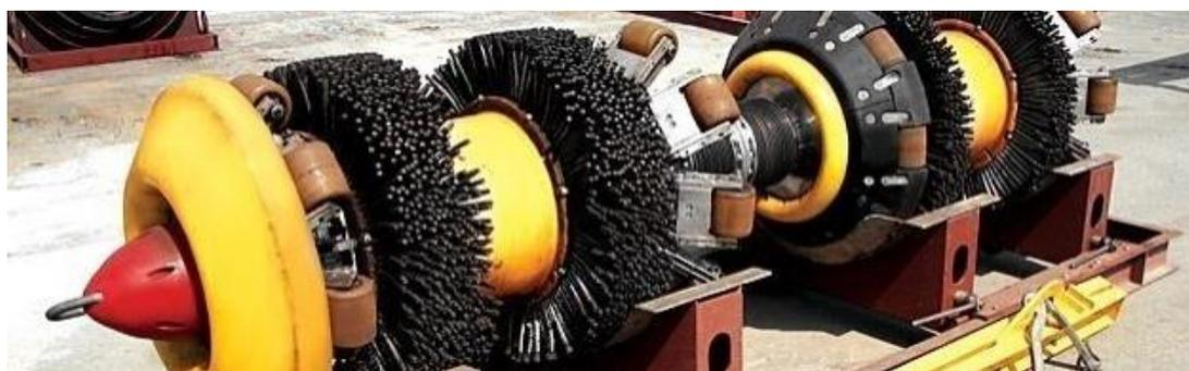
Рисунок 2.3 – Внутритрубный профилемер
