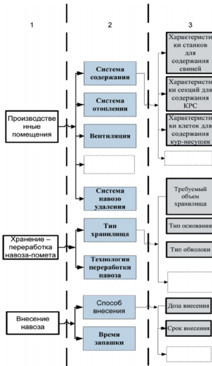
Основные элементы технологий, рассматриваемые в системе НДТ: 1- объекты технологии, 2 - элементы технологии, 3 - показатели, характеризующие элементы технологии
