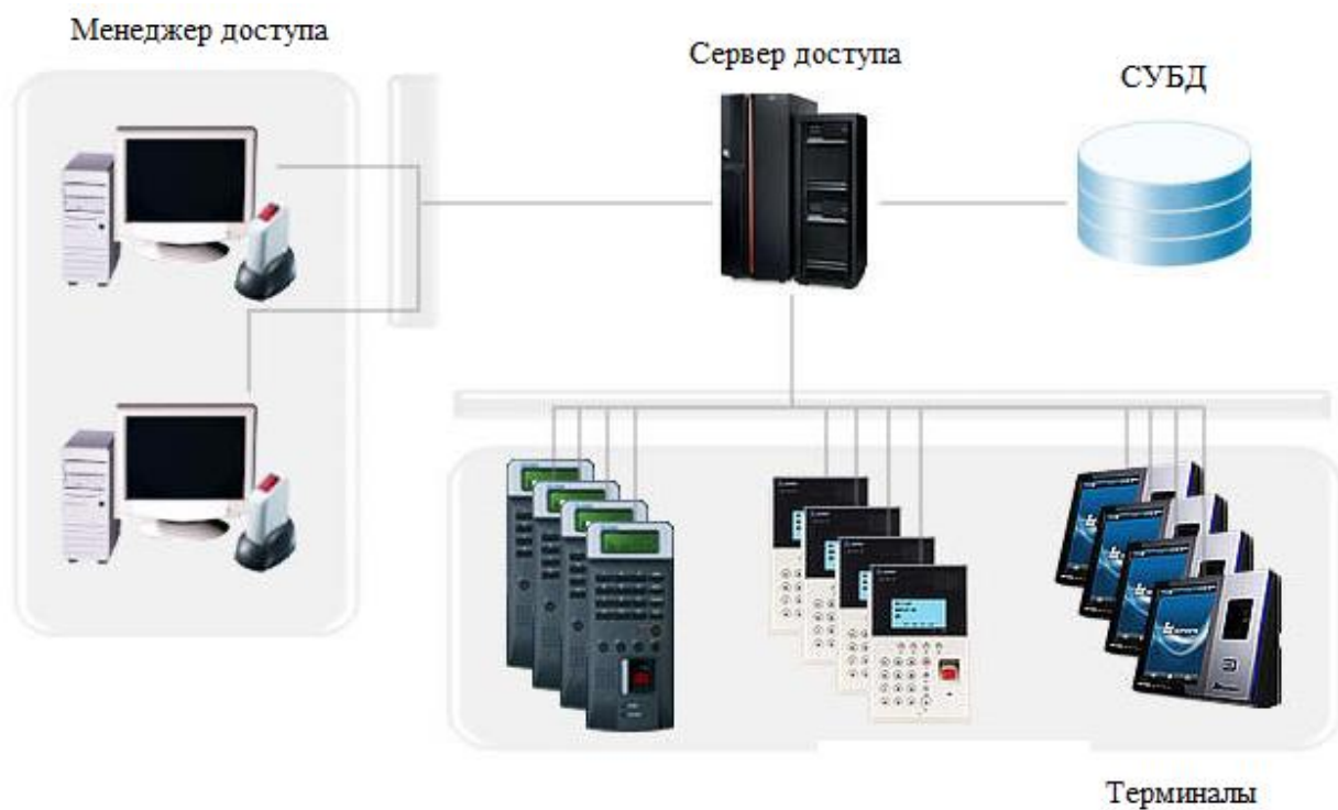
Рисунок 5 – Физическая модель сетевой СКУД
