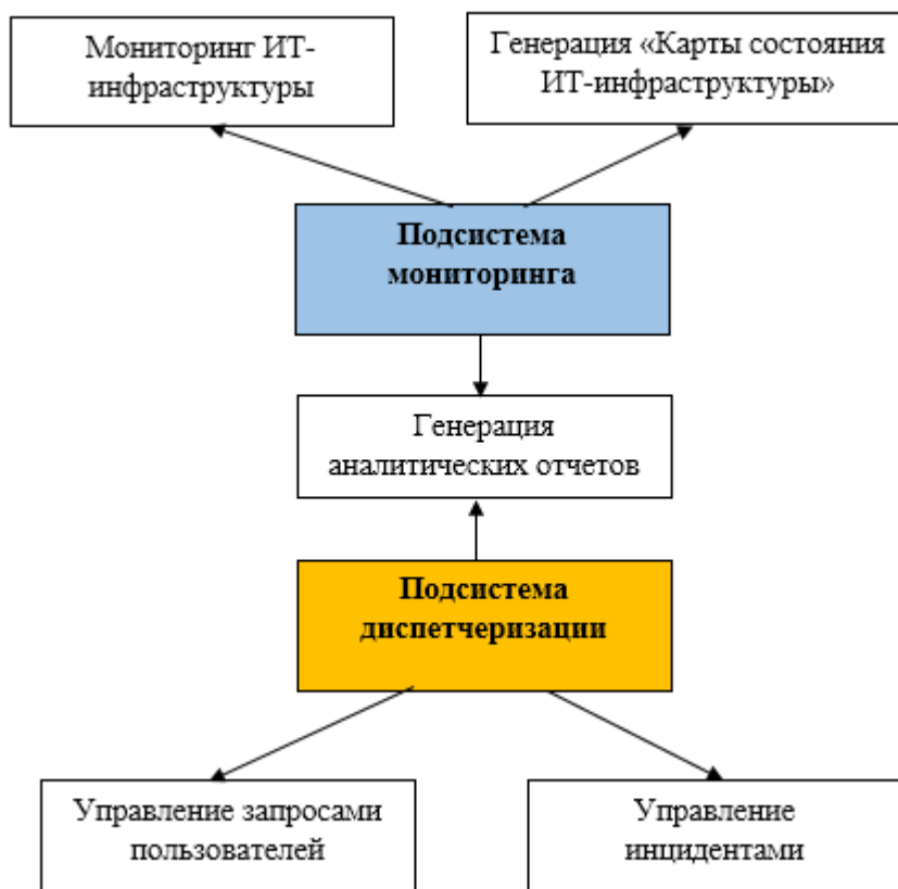
Рисунок 10 – Структурная схема АСМД ИТ-подразделения вуза
