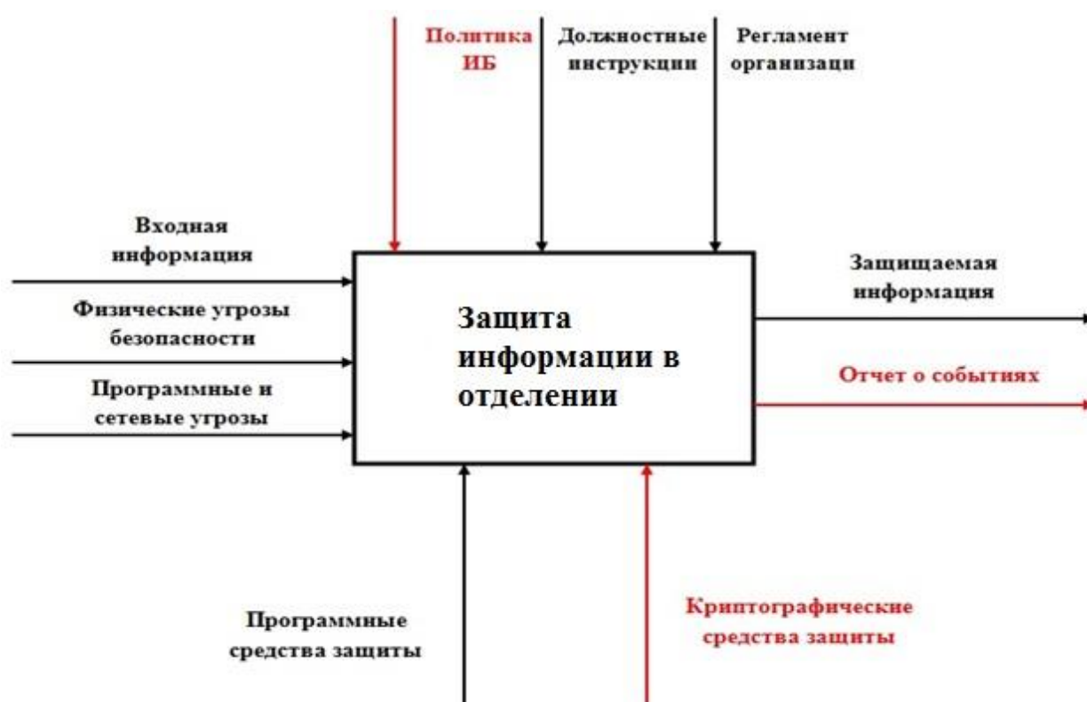
Рисунок 2.2 – Контекстная IDEF0-диаграмма организации СЗИ в информационных системах «КАК ДОЛЖНО БЫТЬ» (0-й уровень)
