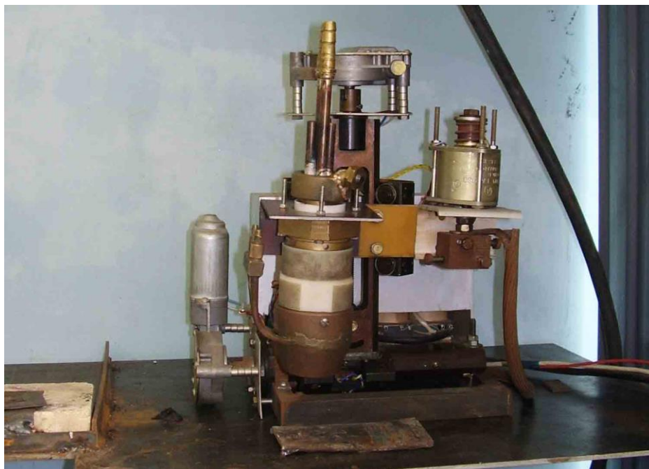
Рисунок 3.18 – Фотография плазмотрона, установленного на рабочем столе.
