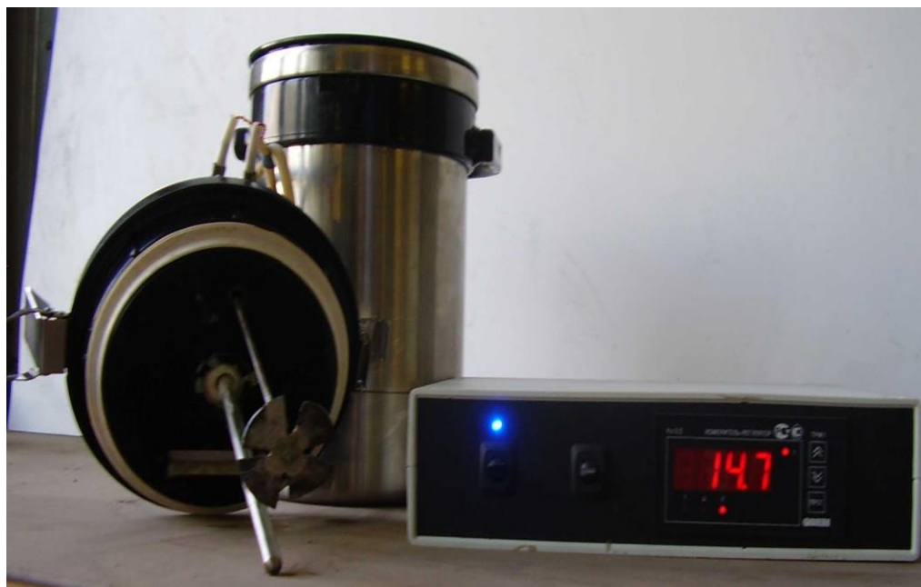
Рис. 3.11 – Фотография калориметра и вторичного прибора ТРМ – 1.
