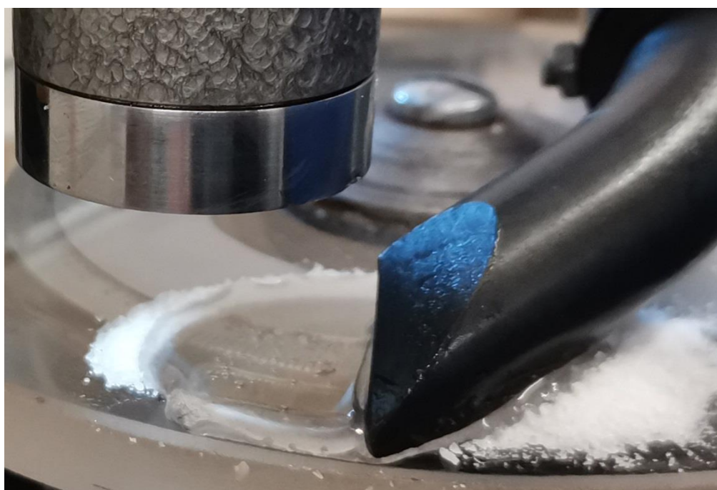
Рисунок 2.4 – Расплавленная ванна смешанных солей
