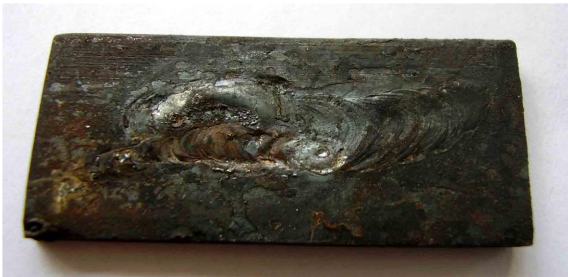
Рисунок 3.12 – Калориметрируемый образец из Ст 3.
