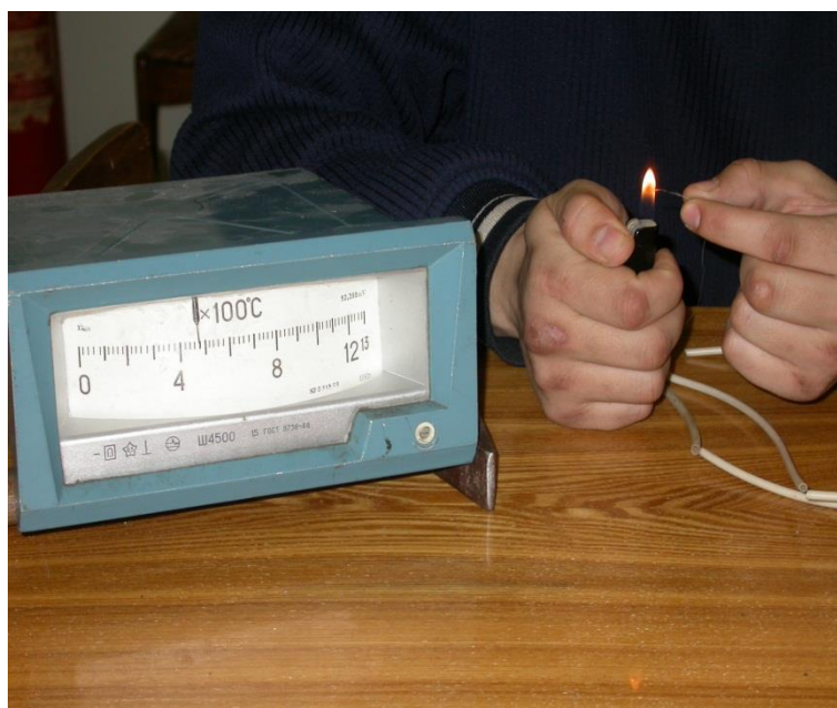
Рисунок 1.6 – Проверка работоспособности термопары
