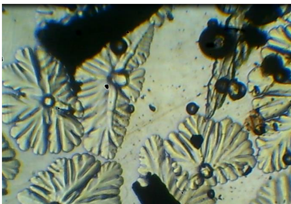
Рисунок 2.6 – Изображение процесса кристаллизации модельного расплава солей
