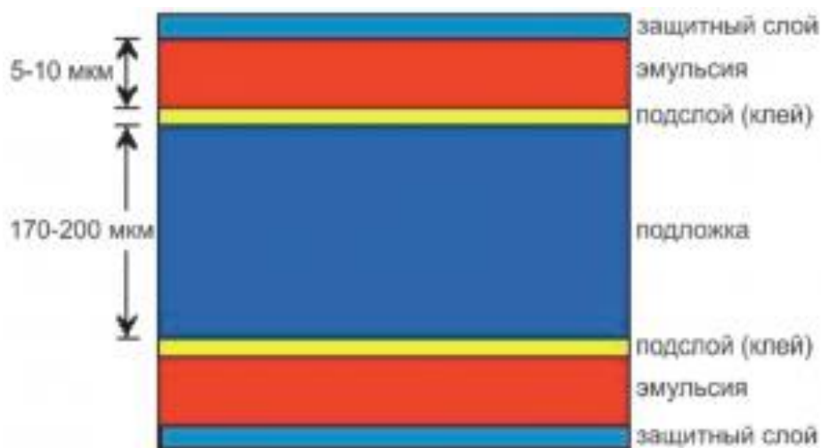
Рисунок 2.19 - Структура радиографической пленки
