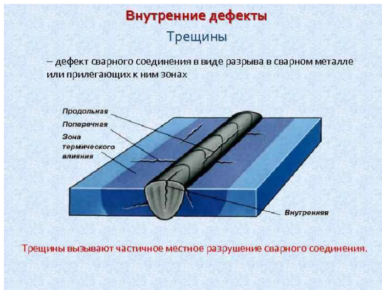
Рисунок 2.8 – Трещины
