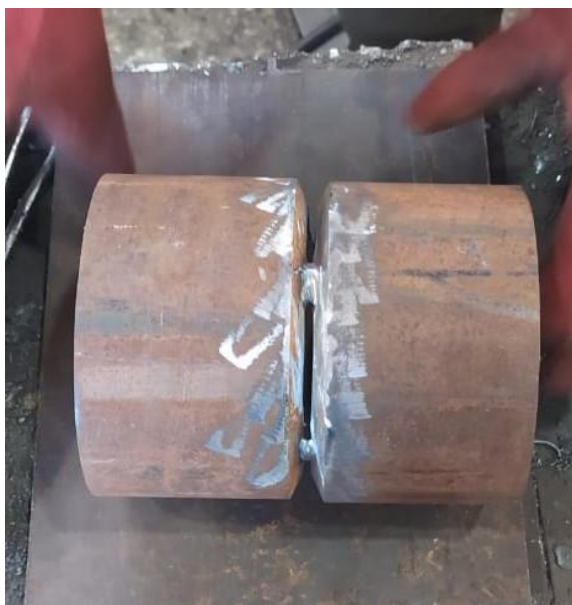
Рисунок 4.3 – Внешний вид прихваток на трубе газопровода
