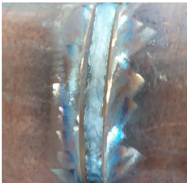
Рисунок 4.5 – Внешний вид заполняющего шва
