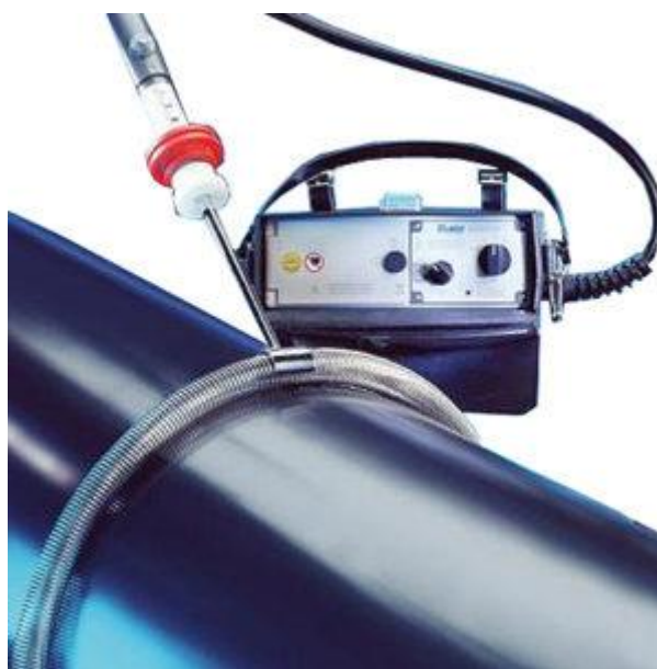
Рисунок 12 – Электрический метод неразрушающего контроля.
