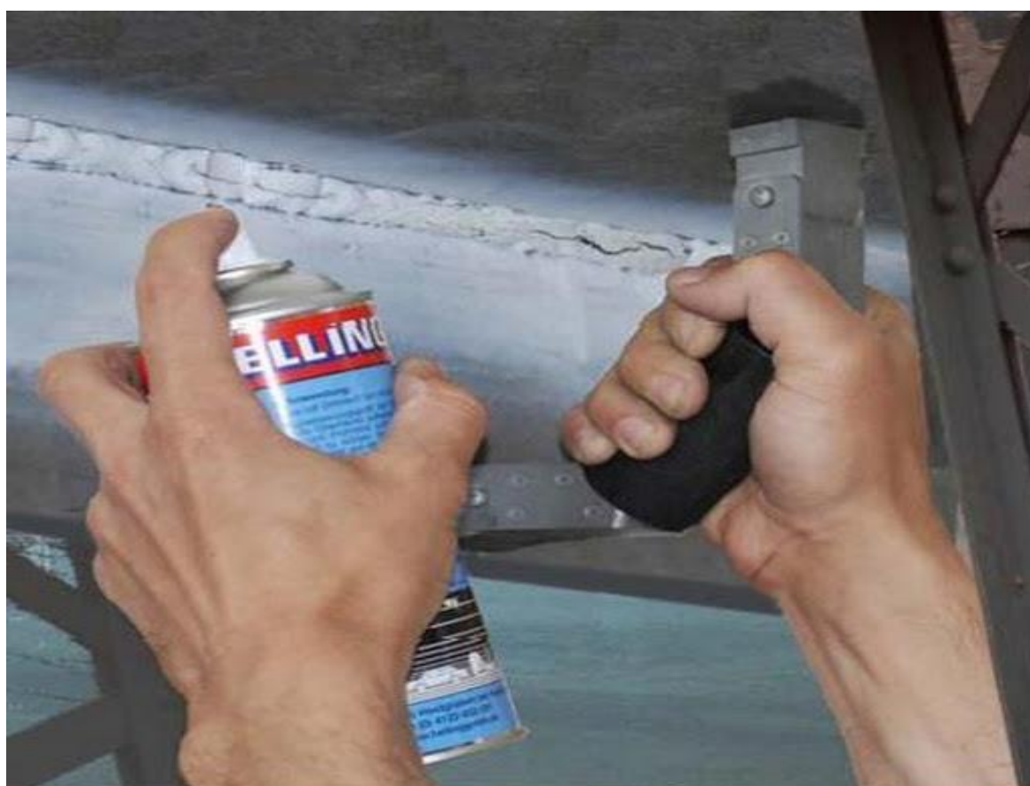
Рисунок 10 – магнитопорошковый контроль способом приложенного поля.
