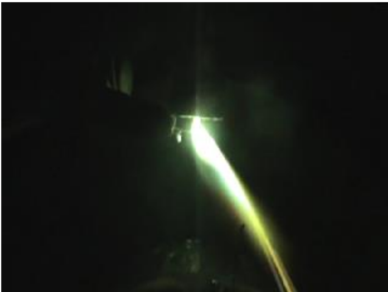
Рисунок 39 – Плавление электродной проволоки в отсутствии детали.
