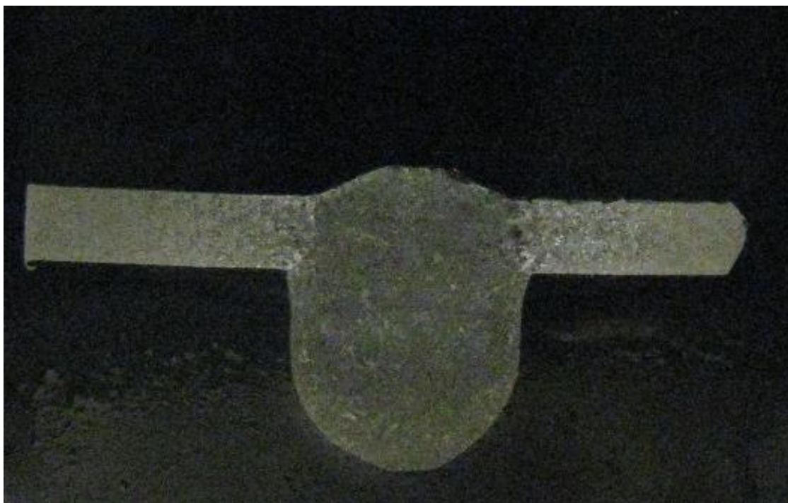
Рисунок 38 – Сквозное проплавление при наплавке на сталь толщиной 1,5 мм
