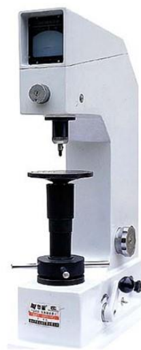
Рисунок 43 – Универсальный твердомер HBRV – 187.5: а – схема определения твердости по Бринеллю, б – внешний вид твердомера
