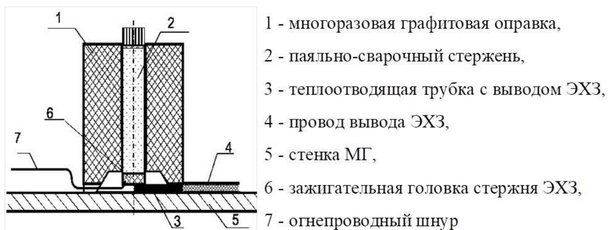
Рисунок 32 – Схема установки графитовой оправки и паяльно-сварочного стержня
