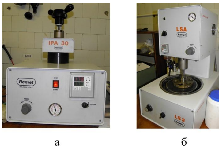
Рисунок 37 – Внешний вид комплекса для изготовления металлографических шлифов: а – пресс, б – шлифовальный станок
