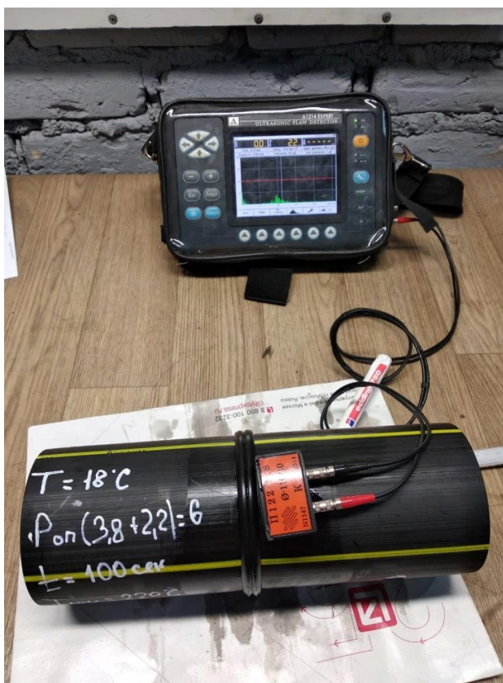
Рисунок 36 – Проведение УЗ контроля сварных соединений полиэтиленовых труб
