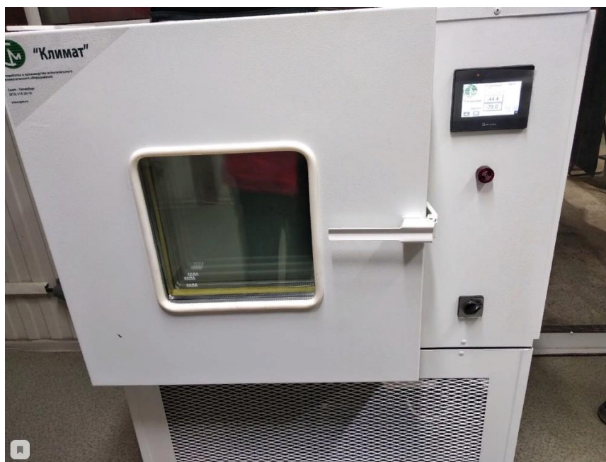
Рисунок 29 - Климатическая камера СМ-60/100-80 ТХ (ТХВ)
