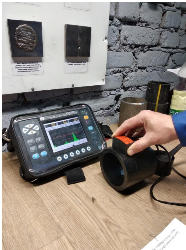
Рисунок 34 - Первоначальная настройка чувствительности дефектоскопа А1214 EXPERT
