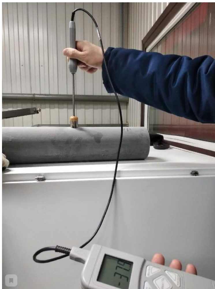
Рисунок 33 - Измерение температуры образцов в процессе охлаждения контактным цифровым термометром ТК-5.04
