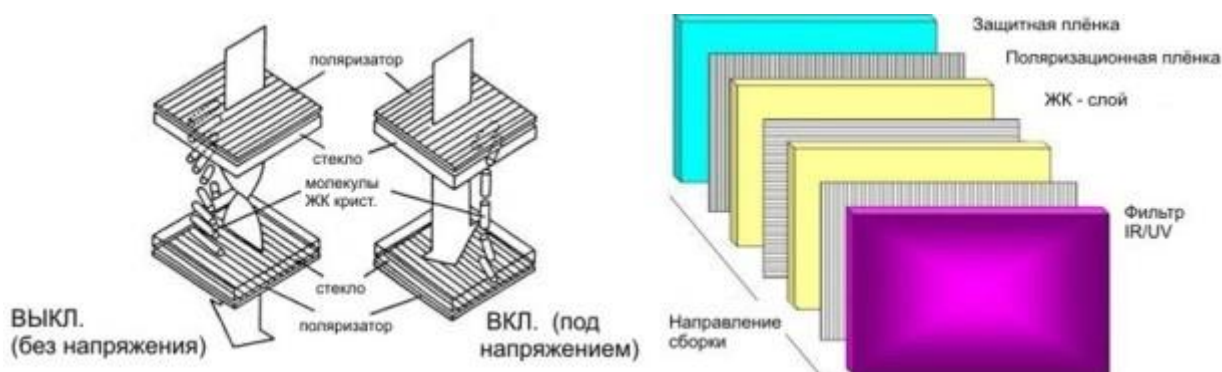
Рисунок 7.3 - Устройство светофильтра «Хамелеон»
