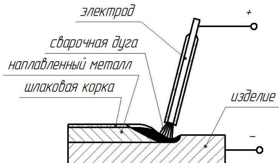
Рисунок 1.5 – Схема выполнения ручной дуговой наплавки покрытыми электродами
