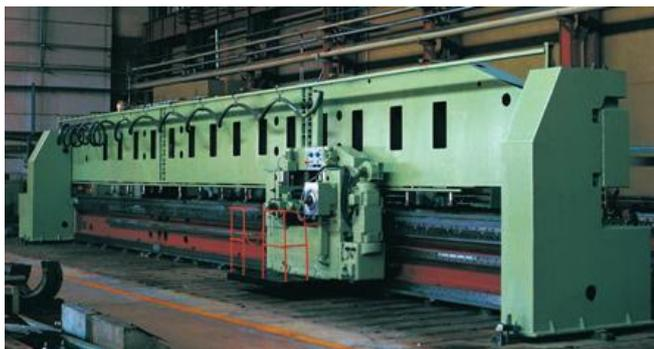
Рисунок 2.2 – Кромкострогальный станок
