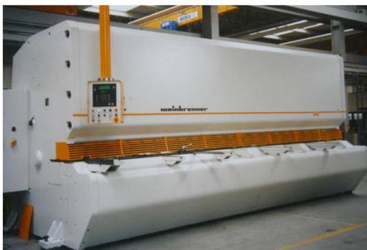
Рисунок 2.1 – Ножницы гидравлические Weinbrenner TSV 20/6050
