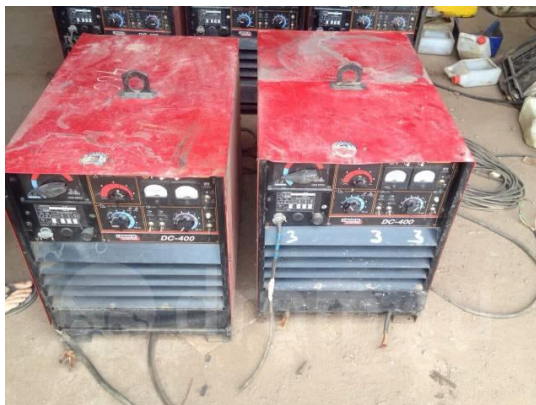
Рисунок 1.3 – Оборудование для выполнения подварочного шва с применением ручной дуговой сварки: источник питания DC400
