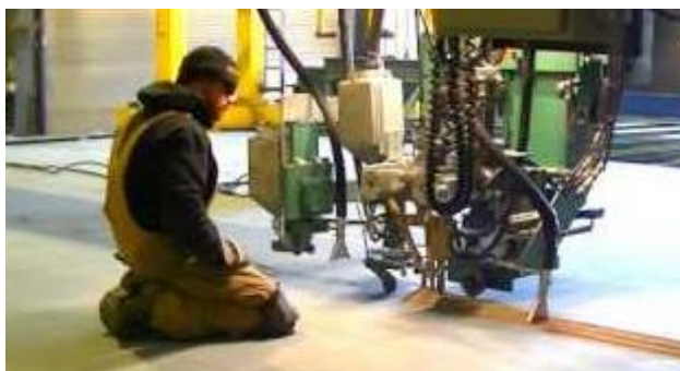
Рисунок 1.4 – Испытание сварочного трактора комплектации фирмы «Ogden»
