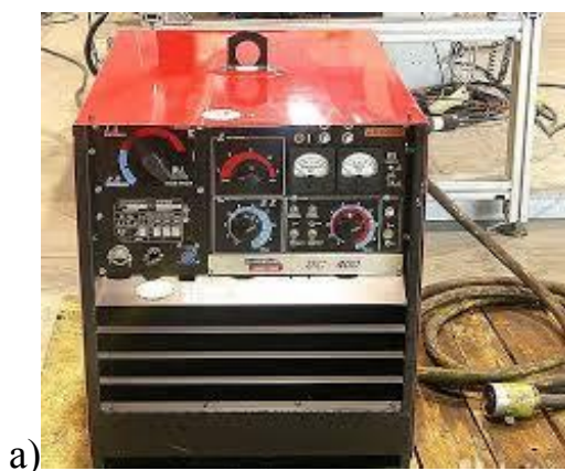
Рисунок 2.10 – Оборудование для выполнения подварочного шва: источник питания DC400 (а) и полуавтомат ПМ 4.33 (б)
