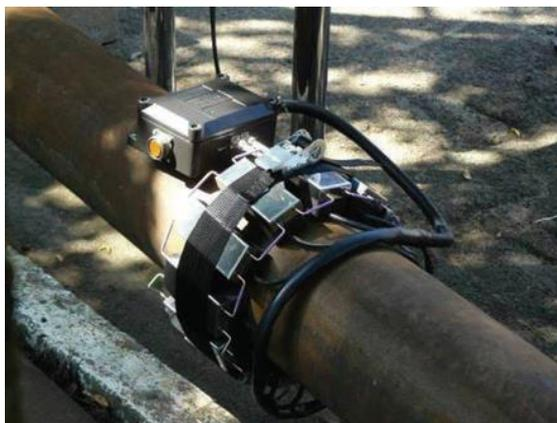
Рисунок 2.1 – Низкочастотная ультразвуковая диагностика магистрального трубопровода
