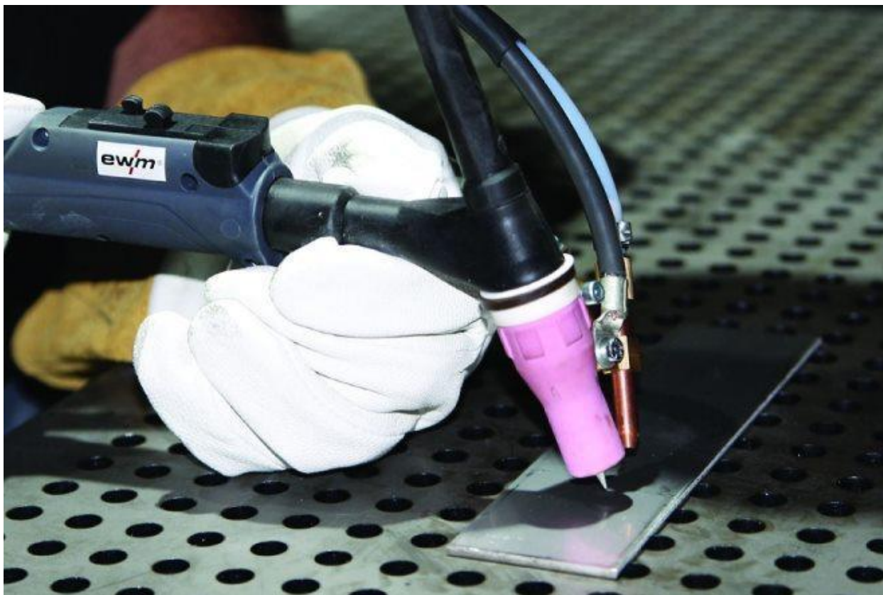
Рисунок 1.9 – Горелка EWM Torch MIG 401 W 4M для механизированной сварки неплавящимся электродом
