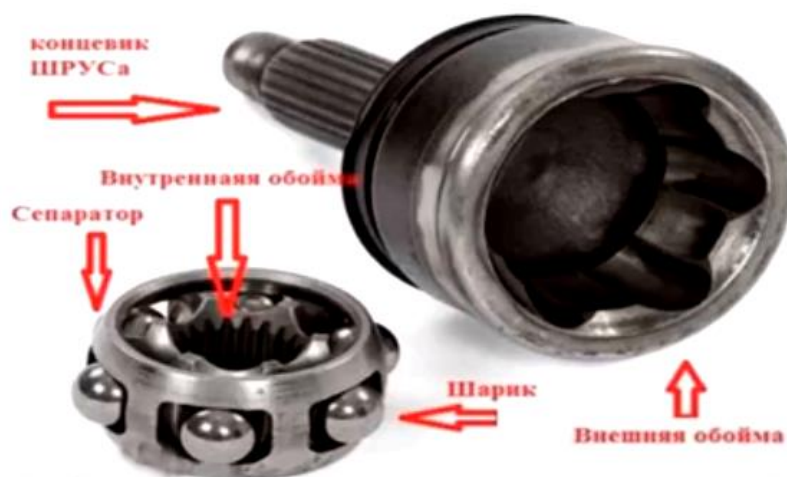
Рисунок 1.10 – Шариковый шарнир – строение сепаратора.
