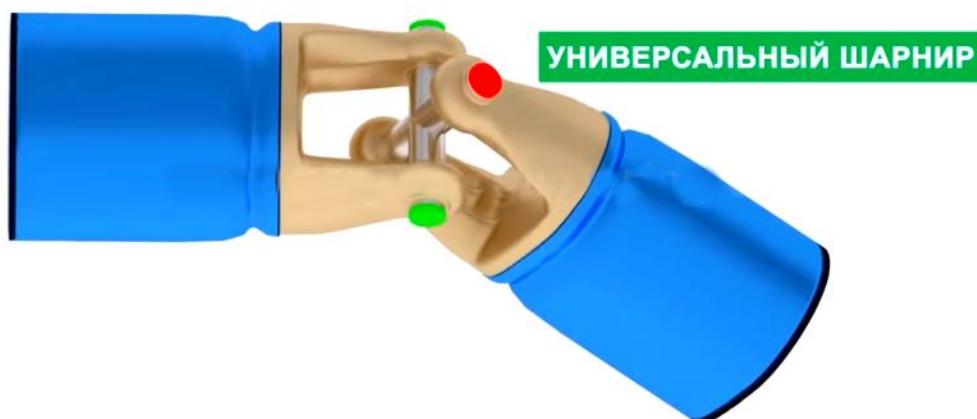
Рисунок 1.2 – Универсальный шарнир модель - схема.
