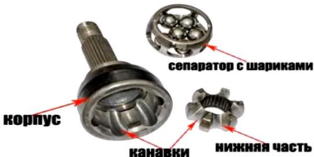
Рисунок 1.9 – Шариковый шарнир – составные детали.
