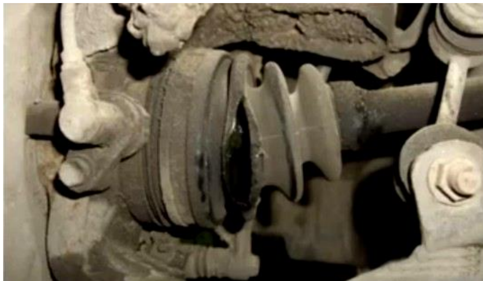
Рисунок 1.11 – Прорыв пыльника шарнира.
