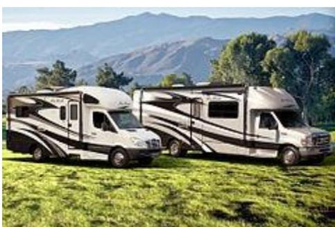
Рисунок 6 - Два автодома класса С, установленные на Фрейтлайнер Сплинтер(слева) и шасси Форд Е-серии(справа) .
