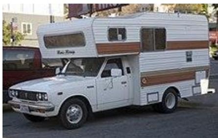
Рисунок 22 - 1978 Toyota Hilux - компактный грузовик с мини-миражем. Это было бы классифицировано как RV, потому что секция кемпера постоянно прикреплена к раме грузовика.
