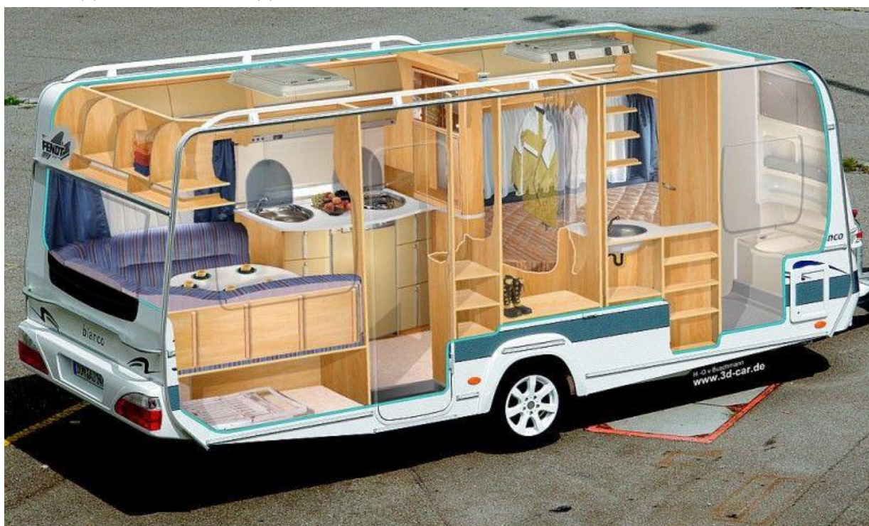
Рисунок 3.2. Одноосный автодом в разрезе
