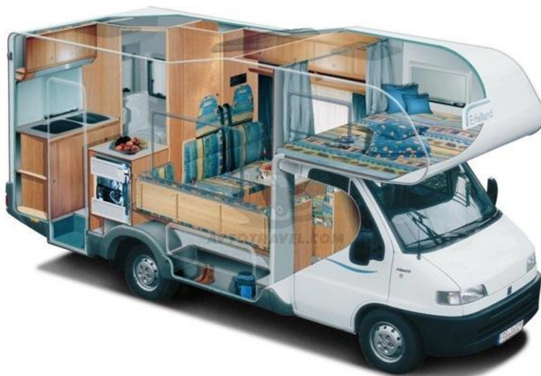
Рисунок 2.2. Интегрированный автодом в разрезе
