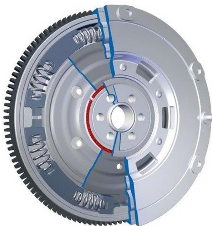
Рис 1.6 - Схема двухмассового маховика
