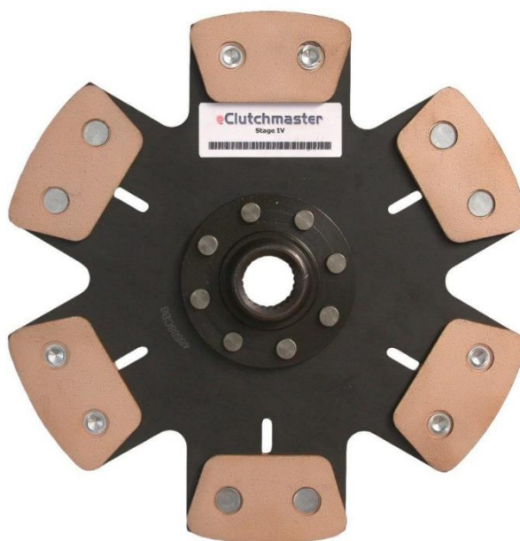
Рис 1.7 - Диск сцепления с керамическими фрикционными накладками
