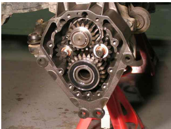
а) с шестернями наружного зацепления
