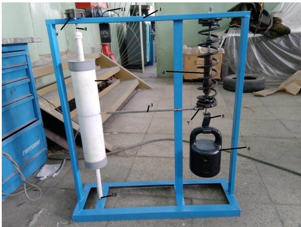
Рисунок 3.1 Схема лабораторной установки для определения собственных колебаний поддресоренной массы
