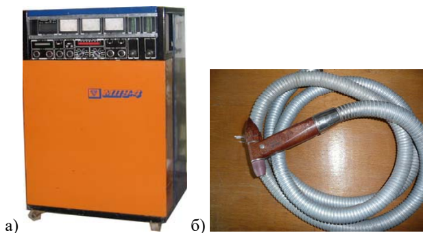
Рис. 2.6. Внешний вид оборудования: а – установка МПУ-4; б – горелка
