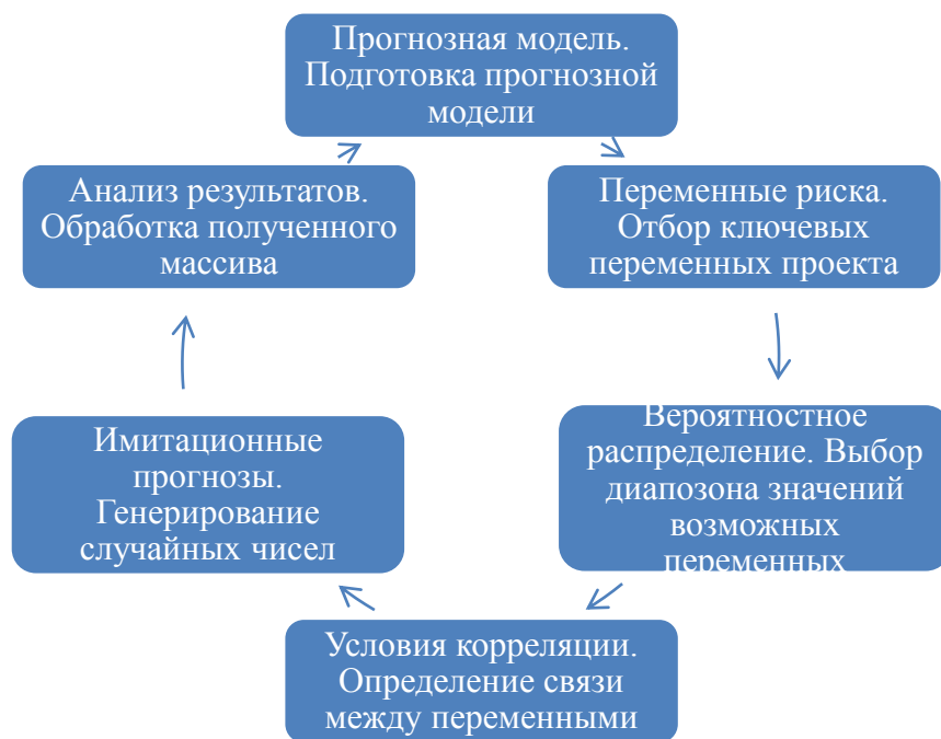
Рисунок 9 – Блок-схема метода Монте-Карло
