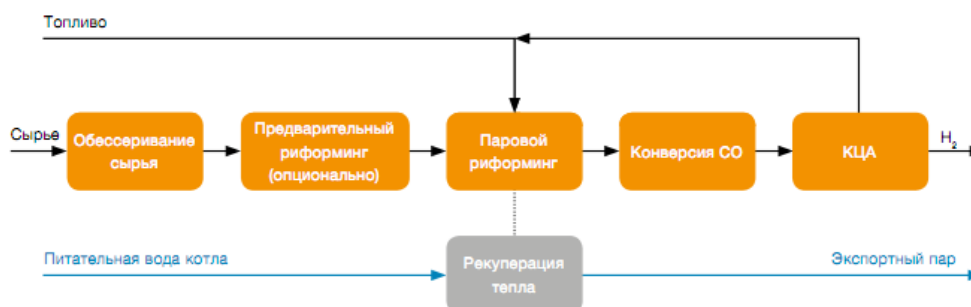
Рисунок 1.1 – Краткая схема видов выполняемых работ на установке получения водорода в АО «Сызранский НПЗ»
