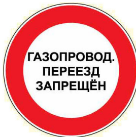
Рис. Р.1. Знак «Газопровод. Переезд запрещен»
