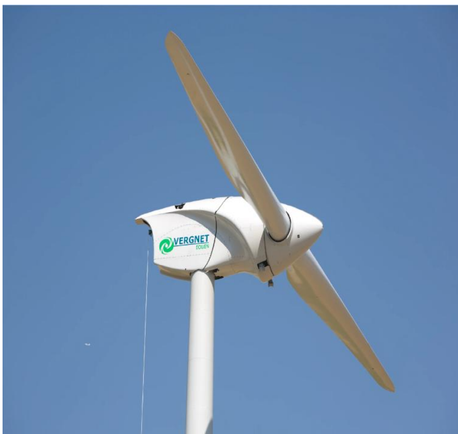
Рисунок 1.4– Внешний вид двухлопастного ветрогенератора
