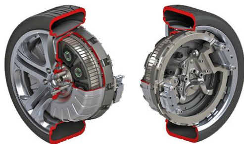
Рисунок 9 - Мотор-колесо в разрезе
