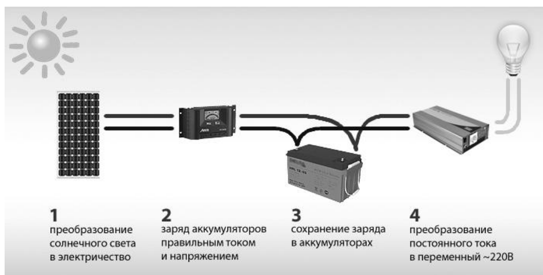
Рисунок 2.1 – Устройство солнечной электростанции
