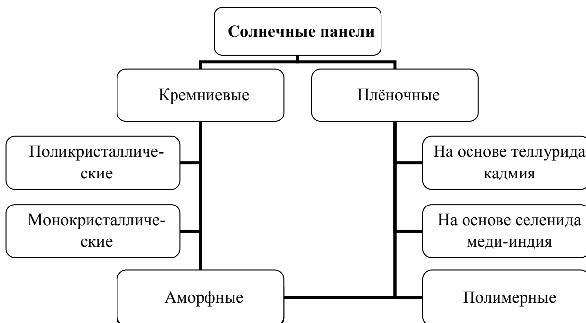
Рисунок 2.3 – Типы солнечных панелей
