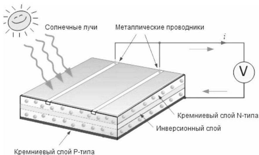
Рисунок 2.2 – Принцип действия солнечной панели
