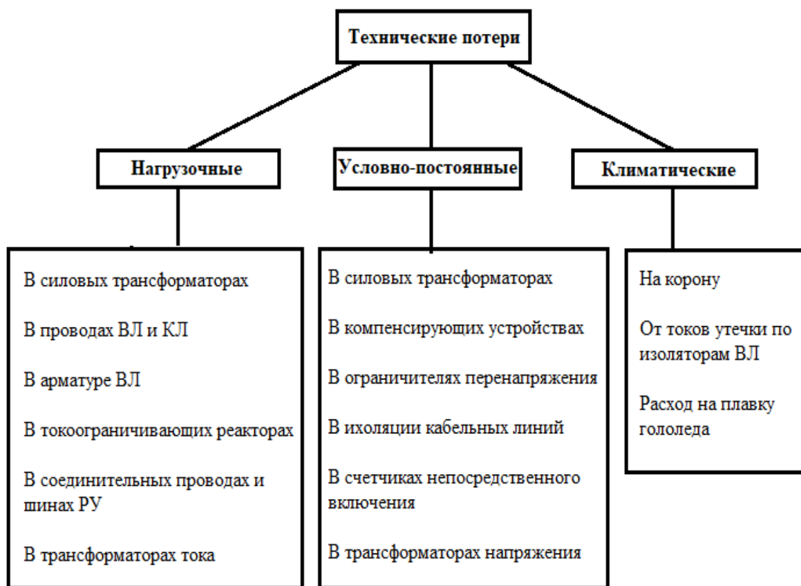
Рисунок 1 – Структура электрических потерь в распределительных сетях
