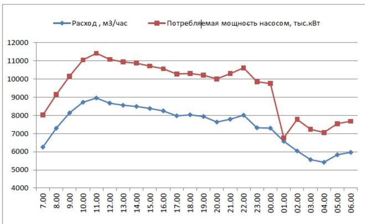
Рисунок 13 – Суточный расход воды и потребления электрической энергии насосным оборудованием цеха ОСВ
