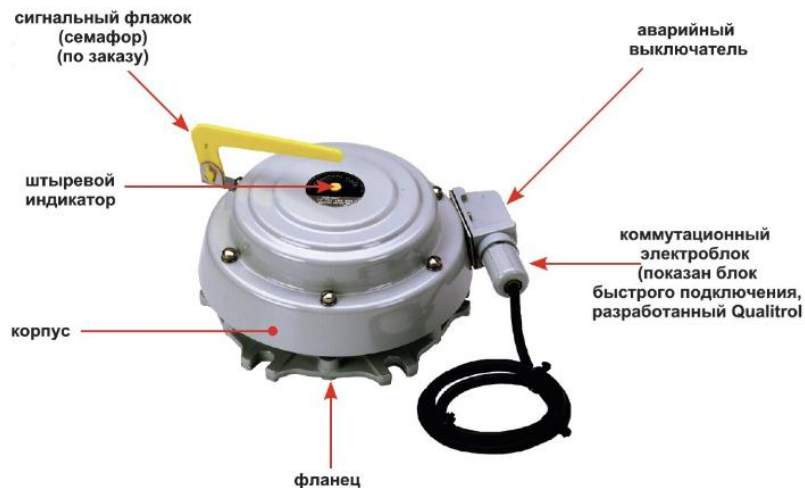
Рисунок 13- Устройство аварийного сброса давления Qualitrol серии LPRD
