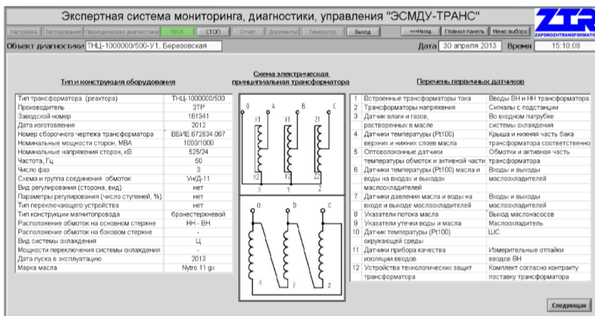
Рисунок 9- Виртуальный прибор со справочными данными на трансформатор ТНЦ-1000000/500-У1 системы мониторинга ЭСМДУ-ТРАНС
