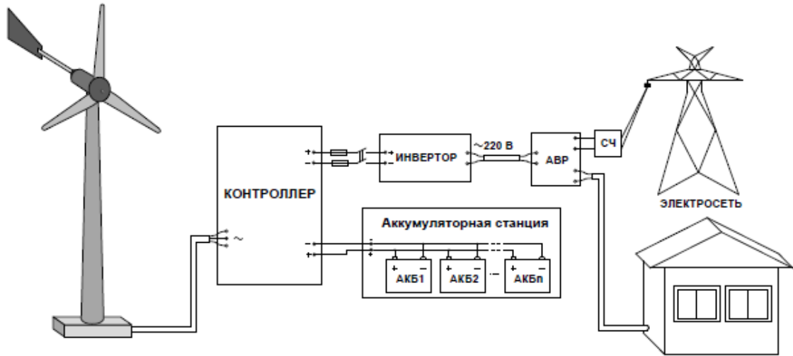
Рисунок 9 – Схема обеспечения электроэнергией с централизованным электроснабжением
