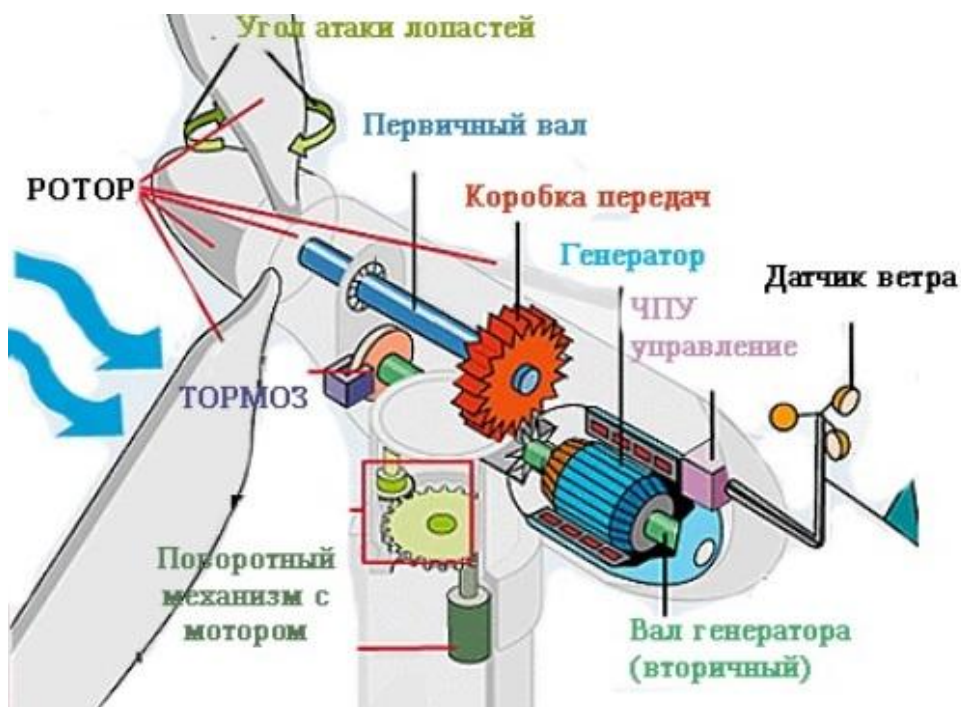
Рисунок 6- Конструкция ветрогенератора горизонтального типа с трёхлопастным винтом
