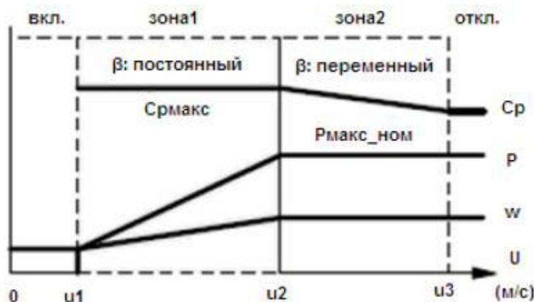
Рисунок 22 – Зоны работы ВЭУ и принцип изменения в них угла наклона
