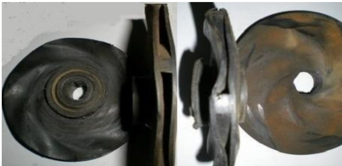
Рисунок 2.3 – Вид деталей погружного насоса из заиленной скважины
