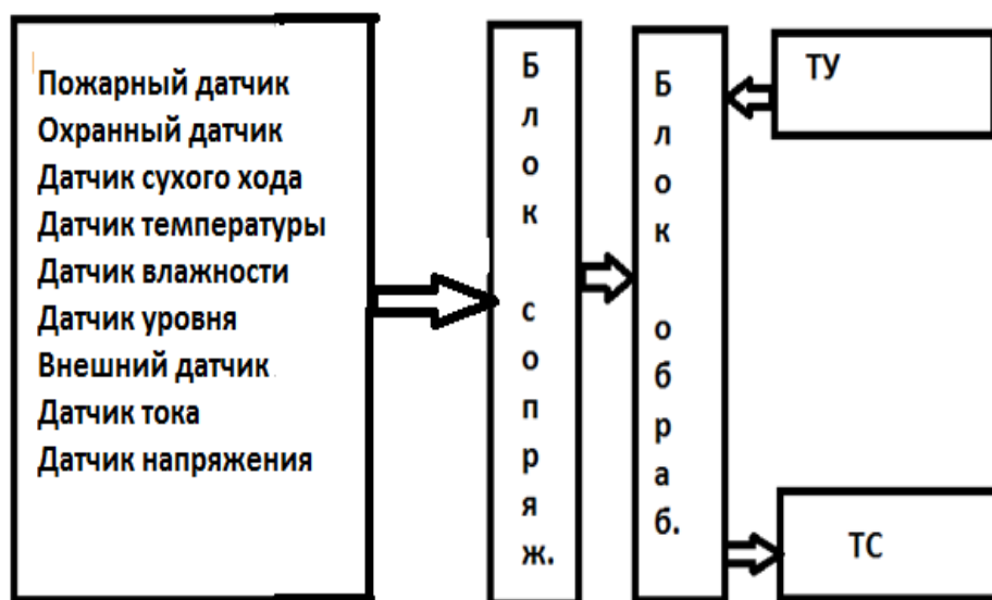
Рисунок 2.4 – Структурная схема блока управления скважиной
