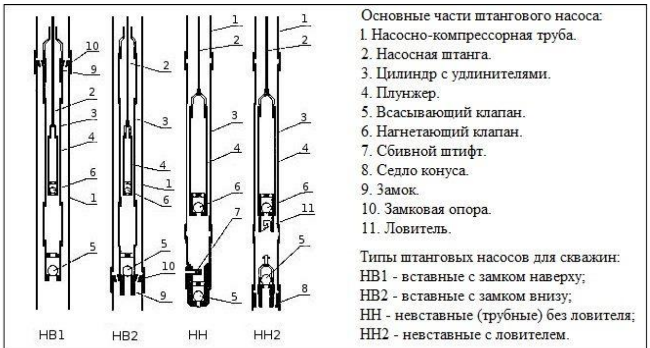
Рисунок 1.9– Устройство штанговых скважинных насосов
