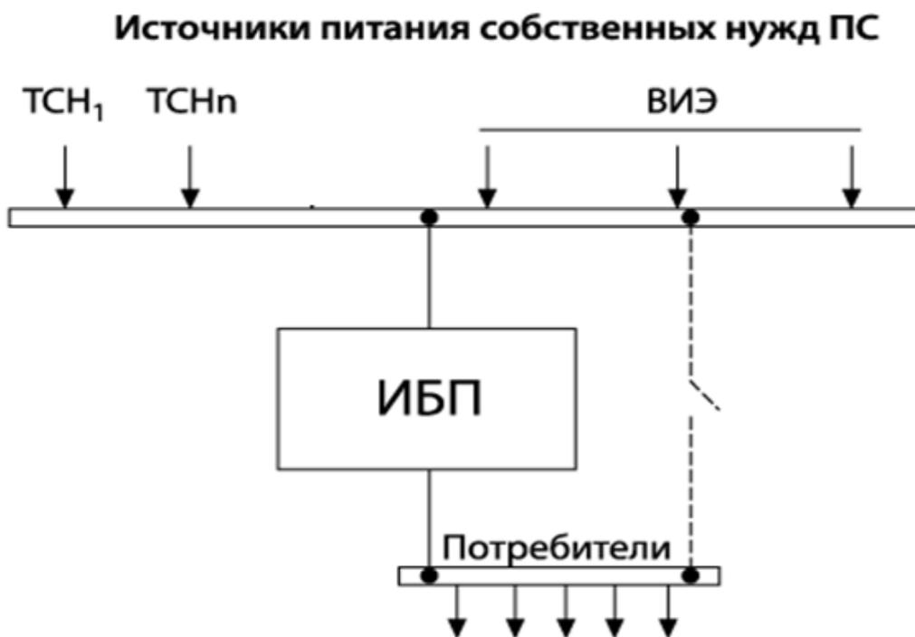
Рисунок 2.7 - Схема питания собственных нужд ПС от ИБП
