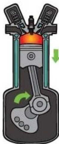
Рисунок 3 – Такт рабочего хода
