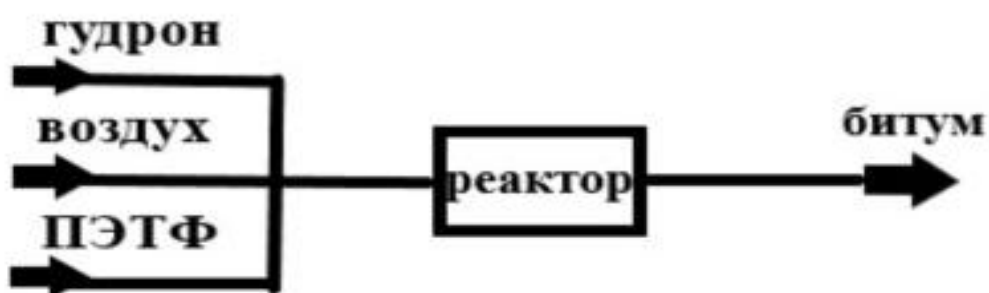
Рисунок 7 – Блок-схема получения модифицированного битума
